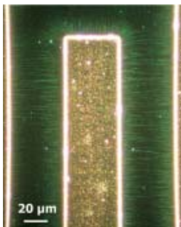
Abb. 5. Lichtmikroskopische Aufnahme von dielektrophoretisch auf einer Goldelektrode abgeschiedenen metallischen CNTs. Die von Krupke et al. kürzlich angewandte Methode erlaubt erstmals, metallische und halbleitende Nanoröhren – wenn gleich in kleinsten Mengen – voneinander zu trennen. 14)
