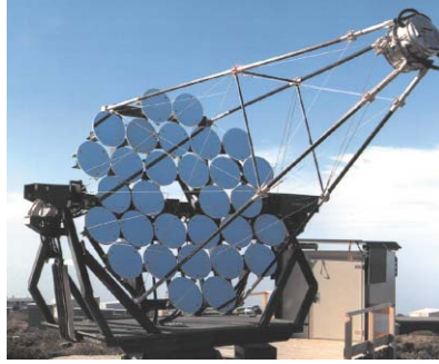
Abb. 2: Eines der fünf gleichartigen Cherenkov-Teleskope des stereoskopischen HEGRA-Teleskopsystems auf der Kanarischen Insel La Palma. Der 8,5-m 2 -Spiegel ist aus einzelnen Segmenten mit je 60 cm Durchmesser aufgebaut und fokussiert das in der Atmosphäre erzeugte Cherenkov-Licht auf die Kamera in der Fokalebene. Die Kamera besteht aus 271 Photomultipliern, die ein Gesichtsfeld von 4,3° Durchmesser überdecken.
